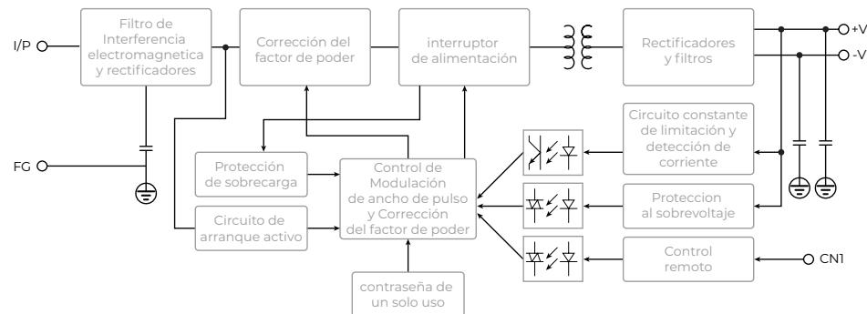
La frecuencia del oscillator: 67KHz
