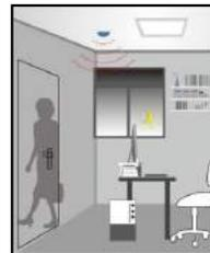
4. Cuando el sensor no detecta movimiento y señal de avance lento, la luz se apagará automáticamente después del tiempo de retraso.
