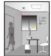
Con suficiente luz ambiental el sensor no enciende la luminaria incluso si se detecta la señal de movimiento.
