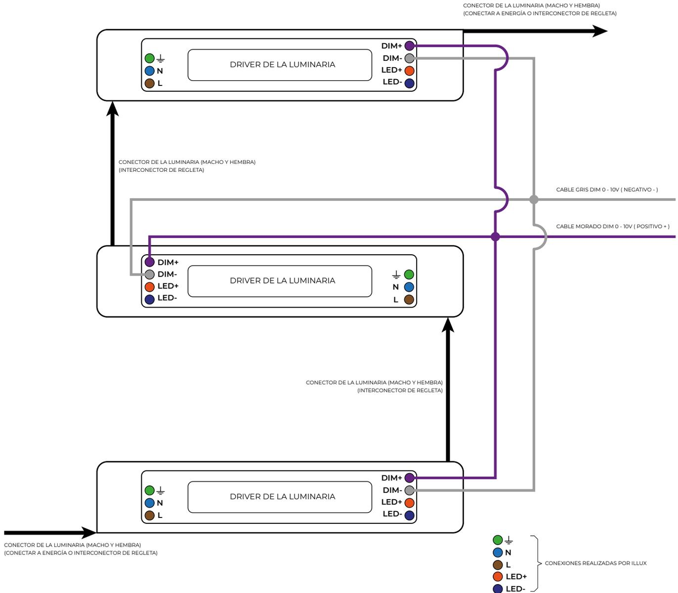
\*\*NOTA: REVISAR DIAGRAMA DE CONEXIÓN DEL DRIVER 0 - 10V Y LA POTENCIA DE LAS LUMINARIAS A INTERCONECTAR PARA NO SOBRECARGAR EL DRIVER
