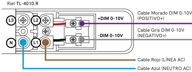
Revise el diagrama y la capacidad de luminarias a interconectar del driver 0 - 10 V~ que va a utilizar.
