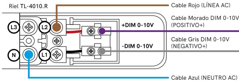
Revise el diagrama y la capacidad de luminarias a interconectar del driver 0 - 10 V~ que va a utilizar.
