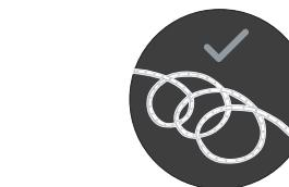
3. Para una correcta manipulación de la tira LED, es fundamental respetar un radio mínimo de curvatura de  $\geq 30$  mm, evitando torsiones, giros bruscos o dobleces en zonas no permitidas. No se debe cortar fuera de las líneas indicadas sobre el PCB, ni permitir que los chips LED queden posicionados en las orillas o vértices de la superficie de instalación, ya que esto puede provocar fallos en el funcionamiento o daños permanentes en los componentes.
